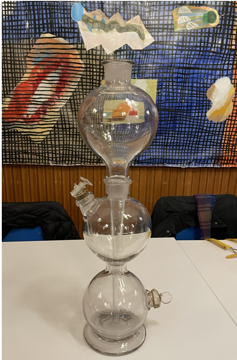
Ifølge oplysning: er fra Nørresundby Apotek "Kipp-apparat" Historie: Det blev opfundet af den hollandske apoteker Petrus Jacobus Kipp i 1844.
