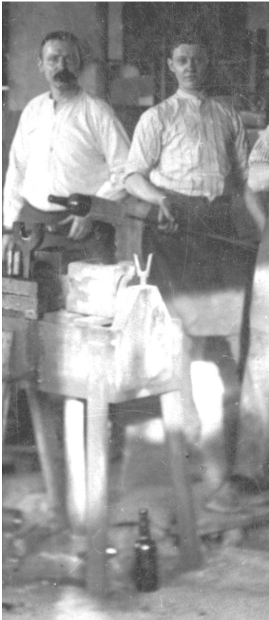
<— — Flaske fremstillet på Esbjerg Glasværk Her vist i en flaskeholder når mundstykket skal formes.
